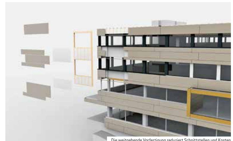
Die weitgehende Vorfertigung reduziert Schnittstellen und Kosten
